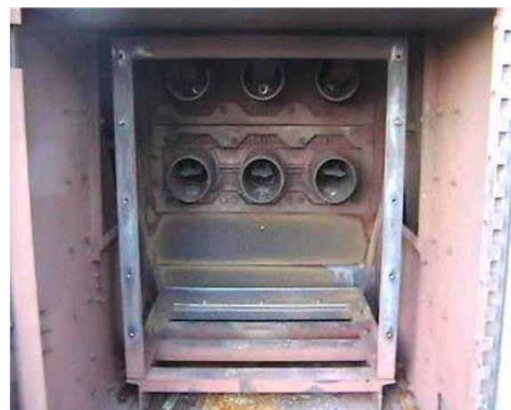
Testergebnis mit 500 ms Lichtbogenzeit
